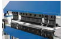
Alle drei Werkzeuge segmentiert und mit Schnellwechselsystem
